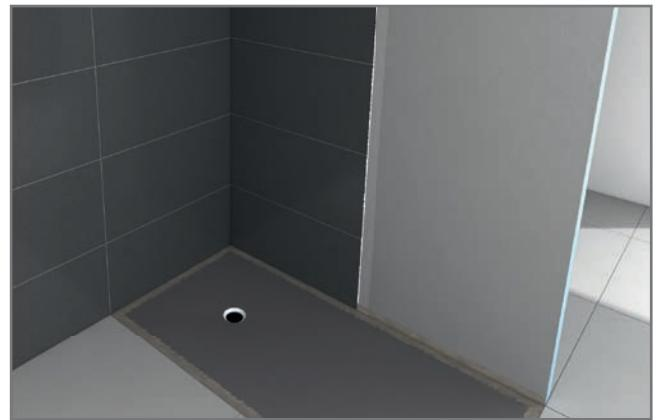
Die wedi Bauplatten lassen sich bei Bedarf zuschneiden, einfach verkleben und direkt verfliesen. Sie stehen auf nahezu jedem Untergrund. Die großformatigen Bauplatten XL und XXL sind bis zu 1,20 m breit. Dadurch gibt es beim Aufbau nur wenige Stoßübergänge. Gleichzeitig sind sie ein „Leichtgewicht“.
