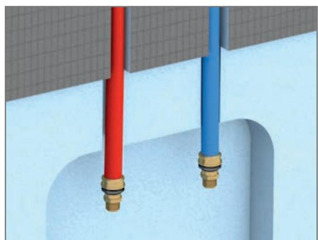
Das wedi Sanwell XS Duschwandmodul ist nur 300 mm breit und 50 mm stark. Es enthält aber bereits alle Komponenten, die für eine Dusche mit Aufputzarmatur notwendig sind. Dazu gehören werkseitig integrierte Kalt- und Warmwasserleitungen und eine Verstärkungsplatte, an der die Duschstange sicher befestigt werden kann. Zudem ist der Aufbau bei Auslieferung zu 100 Prozent wasserdicht.
