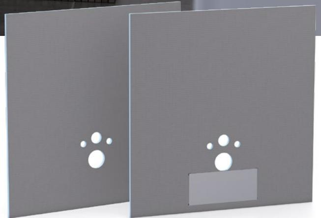
Die komplett vorbereiteten Lösungen zur Verkleidung von WC-Vorwandinstallationen. wedi I-Board eignet sich für die großformatige Verfliesung. wedi I-Board Plus kann dank der werkseitig integrierten Verstärkungsplatte verputzt oder mit Mosaik ab 2 x 2 cm verfliesen werden.
