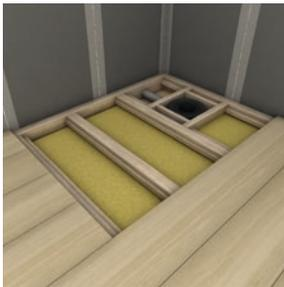
**wedi Fundo Ablauf** passgenau in die Holzbalkendecke montieren.
