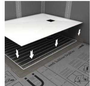
Passende **wedi Fundo Top Designoberfläche** mit **wedi 610 Kleb- und Dichtstoff** montieren.
