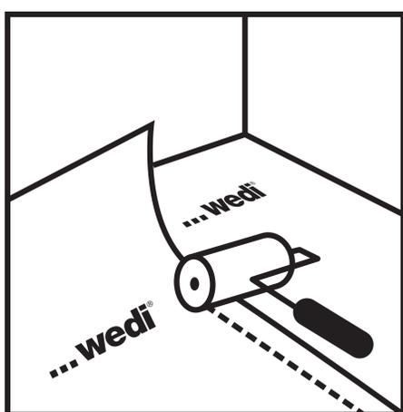
(F) Poser la seconde bande et faire pression sur la zone de chevauchement à l'aide d'une taloche ou d'un cylindre en caoutchouc.
