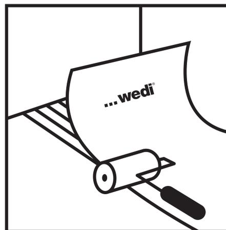
(F) Faire chevaucher les joints des bandes sur environ 5 à 10 cm. Placer de l'enduit d'imperméabilisation à base de ciment (wedi 520) dans la zone du chevauchement.
