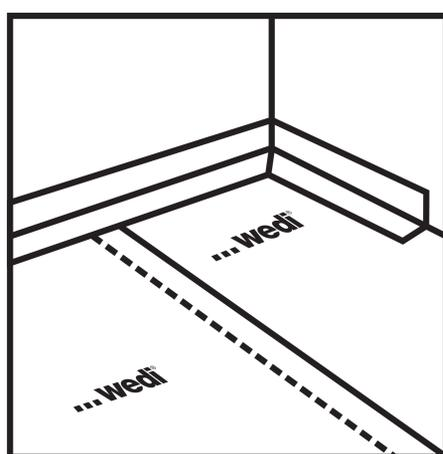
(F) Assurer l'étanchéité des joints d'angle et des raccordements au sol à l'aide de la bande d'étanchéité wedi et d'enduit d'imperméabilisation à base de ciment (wedi 520). Placer la bande d'étanchéité au milieu du joint.
