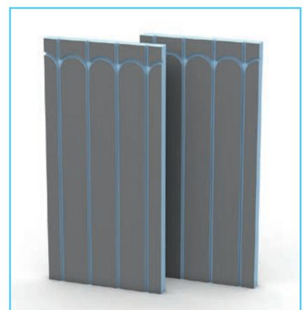
Das Bad soll eine Fußbodenheizung bekommen? Dann ist die vorgefertigte wedi PreLine die richtige Wahl für die energetische Badsanierung. Die Platte hat bereits werkseitig eingearbeitete Aussparungen für die wasserführenden Rohre.
