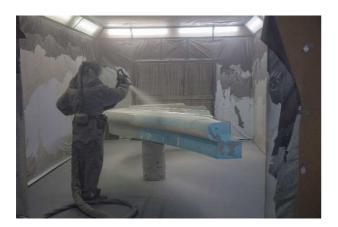
Dort wurden die Elemente aus Polystyrol-Hartschaum mit einem speziellen Mehrschichtenaufbau überzogen. Eine dieser Schichten ist ein Polyurea-Material. Diese sorgt für die außergewöhnliche Stabilität der Bankelemente.
