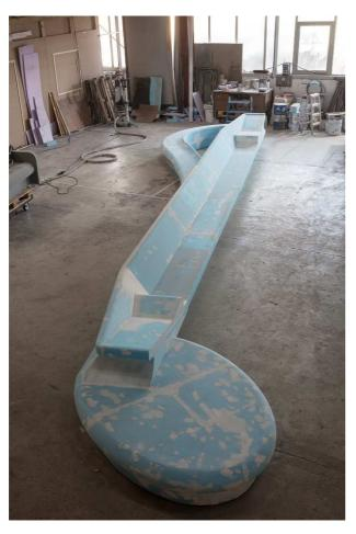
Die Sitzbänke wurden auf individuelle Pläne hin von wedi exakt nach Maßgabe gefertigt und testweise aufgebaut. Im Anschluss wurden die Teile auseinandergenommen und zur Weiterverarbeitung in Hallen von pilzdesign gebracht. Die komplett zusammengefügten Großteile von einer Länge von bis zu zwölf Metern wurden in einer speziellen Lackierhalle endbeschichtet.
