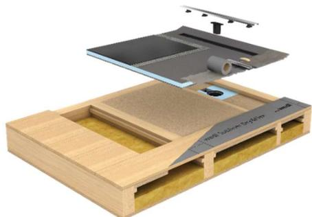
Le siphon se trouve entre les solives dans la réservation de l'installation, l'élément de douche étant placé exactement au-dessus.
