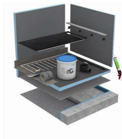
Qualunque sia la soluzione di progettazione scelta: Le docce a livello del pavimento devono essere sempre collegate saldamente al sistema di impermeabilizzazione della stanza umida e devono essere impermeabili in modo permanente. In linea di principio, è opportuno installare tutti i componenti sono coordinati tra loro e sono stati testati e approvati dalle autorità edili.
